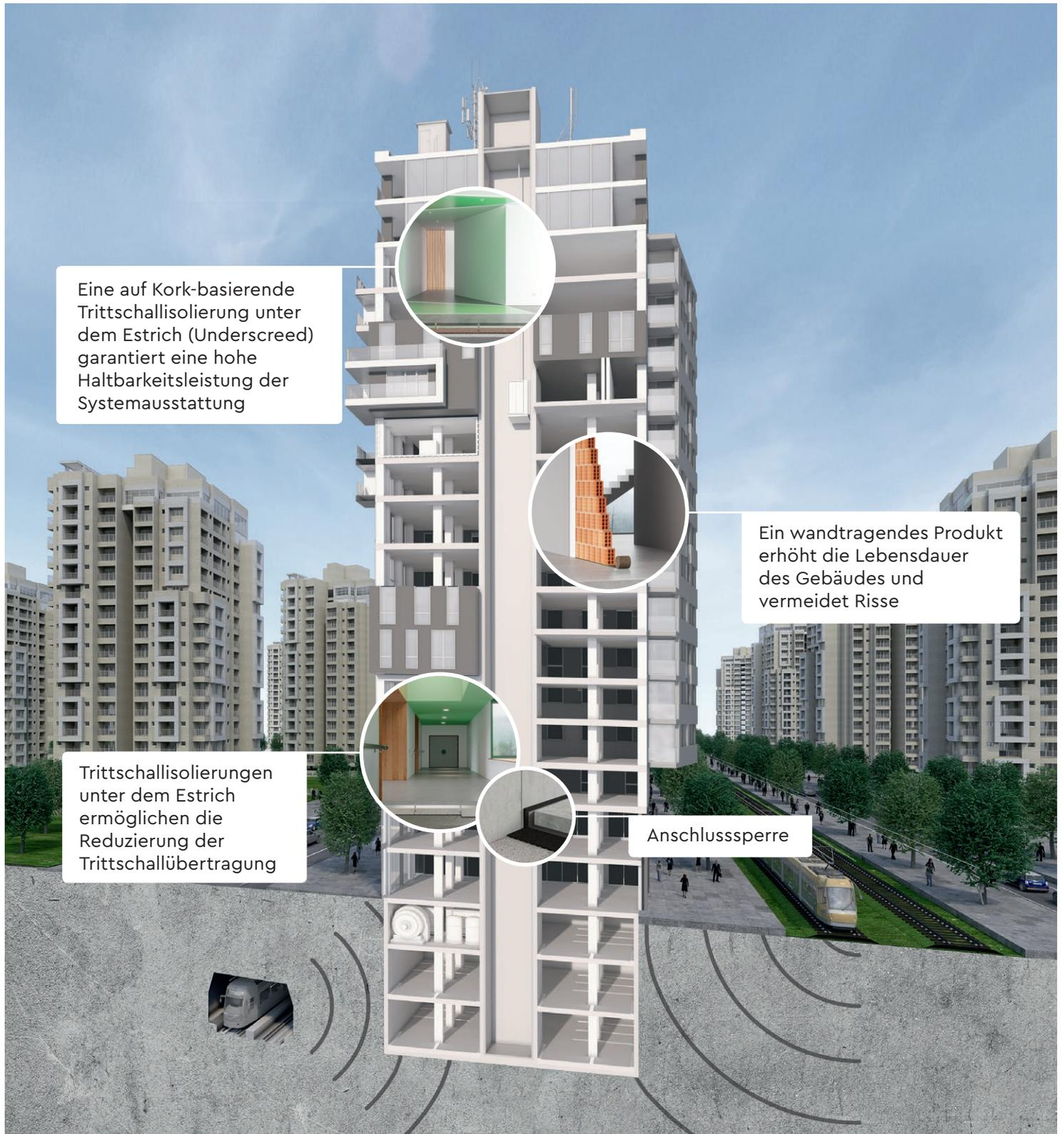
Eine auf Kork-basierende Trittschallisolierung unter dem Estrich (Underscreed) garantiert eine hohe Haltbarkeitsleistung der Systemausstattung
