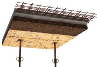
Tetos + Outras Aplicações Sistema decofragem perdida
