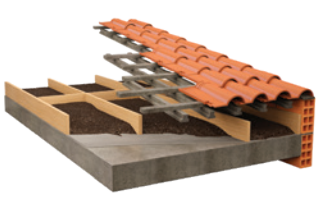
Cobertura Enchimento de caixas sobre laje esteira
