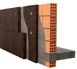
Parede Exterior Revestimento exterior à vista sobre isolamento
