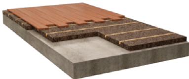
Laje e Pavimento Betonilha de enchimento (betão leve)
