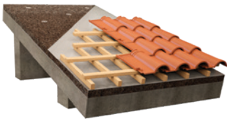
Cobertura Inclinada tradicional com tela de vapor
