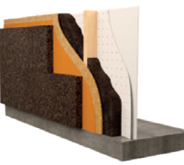
Parede Exterior Revestimento exterior à vista sobre estrutura madeira
